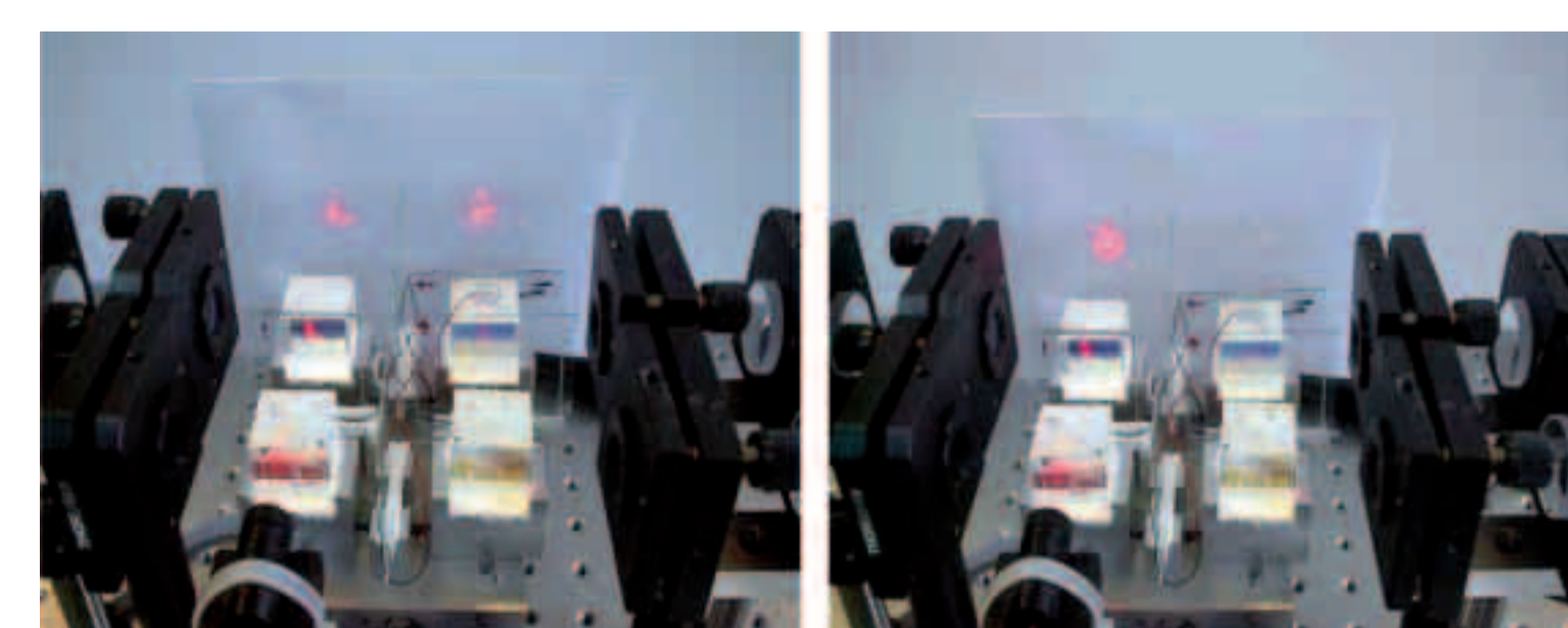
Figura 2. Línea A2: Funcionamiento del conmutador 2 x 2 con tecnología CL en modos directo y cruzado.
